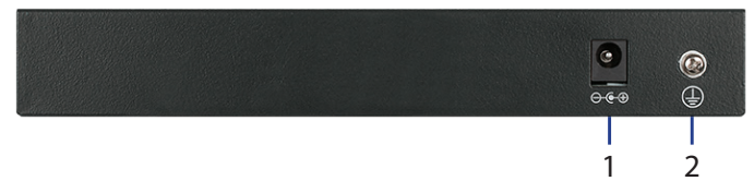
Рисунок 3: Компоненты задней панели
