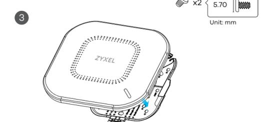
**SE** **1** Fästa två klämmor på taggaller enligt bilden. **2** Skruva fast två skruvar som håller fast fästet klämmorna. **3** Dra NWA50AX på fästet tills det klickar fast.
