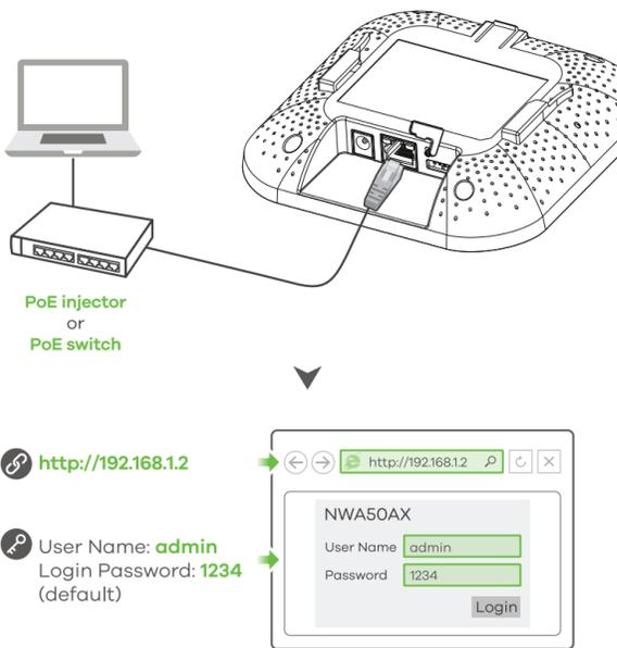
**SE** **1-b** Använd en Ethernet-kabel för att ansluta en dator till NWA50AX **UPLINK-port** via en PoE-injektor eller PoE-omkopplare. Använd den DHCP-tilldelade IP- eller statiska IP-standardadressen "http://192.168.1.2" för att öppna webbkonfiguratorn. Kontrollera att datorns IP-adress finns i samma delnät som NWA50AX.
