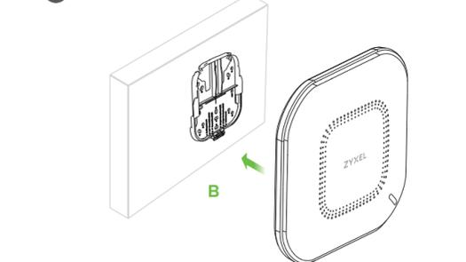
**SE** **2** Installera de två monteringskruvarna i hålen i fästet (B) i pluggarna/förankringarna för att säkra fästet i väggen/taket. Se till att skruvarna ligger tätt och säkert mot väggen/taket.
