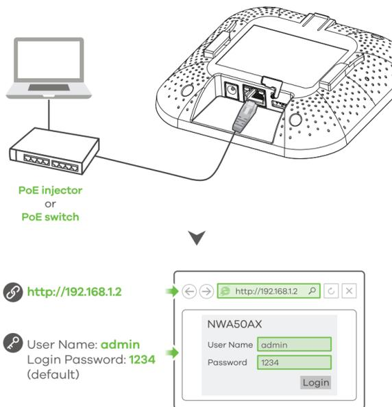
**CZ** **1-b** Pomocí ethernetového kabelu připojte počítač k portu **UPLINK** zařízení NWA50AX přes injektor nebo přepínač PoE.
