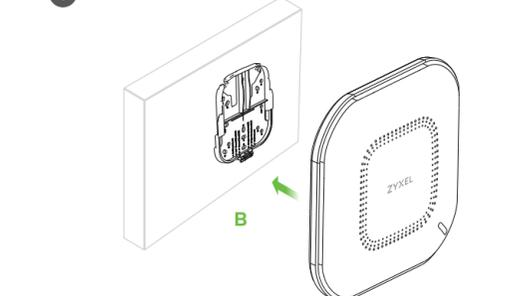
**CZ** **2** Skrze otvory v rámu (B) provlékněte dva šrouby a ty vsadte do hmoždinek; tím zajistíte rám na zeď/strop. Zkontrolujte, zda jsou šrouby pevně a bezpečně upevněny do zdi/stropu.
