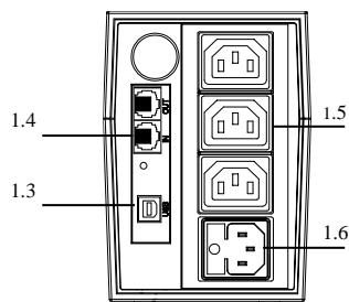
Задняя панель модели без коммуникационного порта или с портом USB (оpционально) с разъёмами EURO
