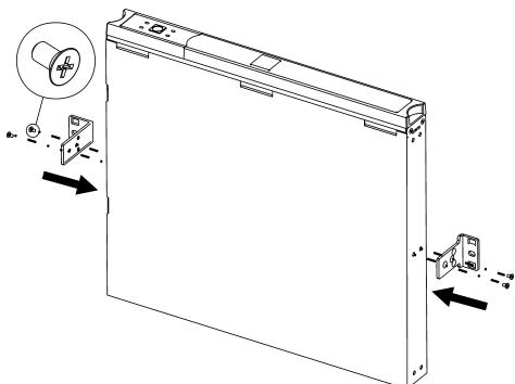
2 Примечание: Если это возможно, вкрутите два винта в дюбели. Если монтаж при помощи дюбелей невозможен, используйте расширяемый стеновой анкер. Крепеж в комплект не входит; рекомендуется использовать шурупы с квадратной головкой 0,25" x 2". Монтируйте ИБП в одном из приведенных положений.
