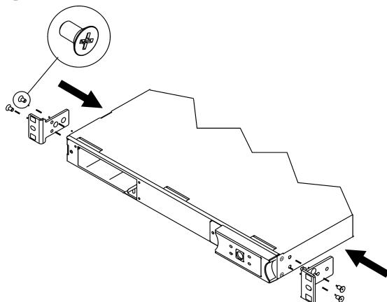
5 Закрепите зажимные гайки в стойке и закрепите кронштейны входящими в комплект винтами.
